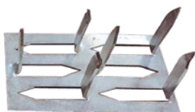
Wandkralle 88 x 52 x 1,0 mm Nägel 35 mm lang
