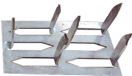
Wandkralle 88 x 52 x 1,0 mm Nägel 35 mm lang
